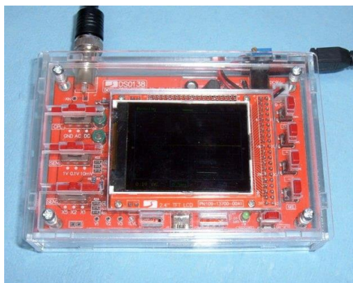
Рисунок 2 – Цифровой осциллограф после сборки
