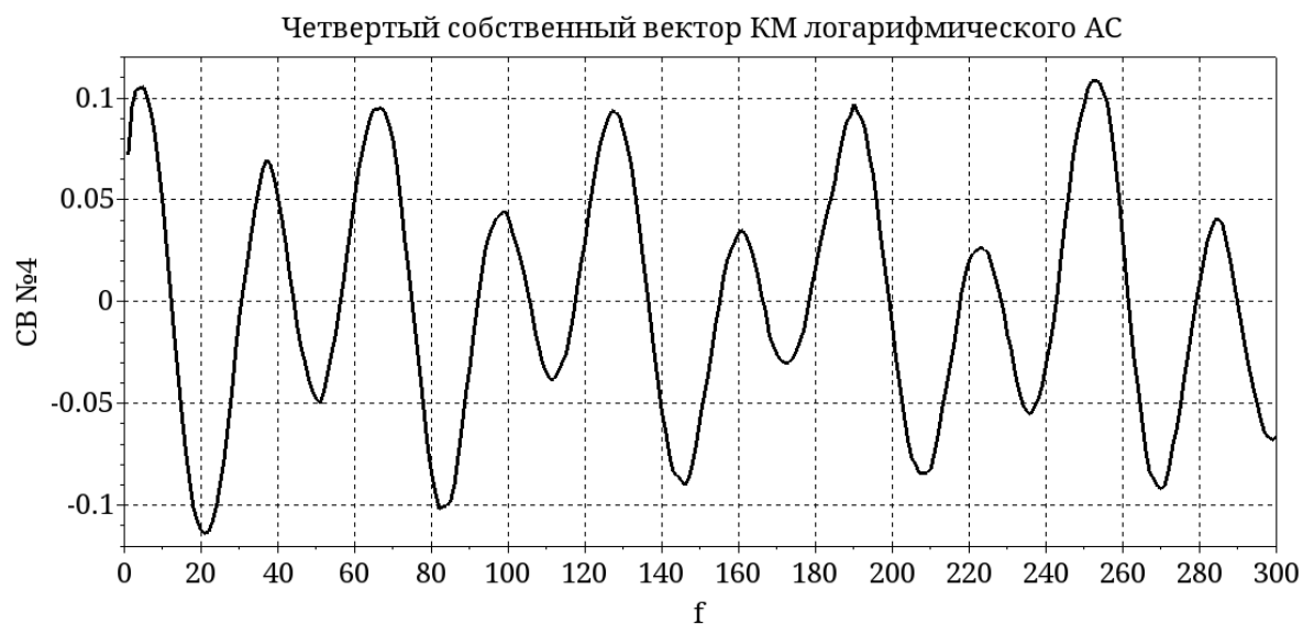
Рис.4. Четвёртый (по убыванию собственных значений) собственный вектор ковариационной матрицы, построенной на интервале анализа 300 дискретов в частотной области (для среднего логарифмического амплитудного спектра, показанного на рис.1).
