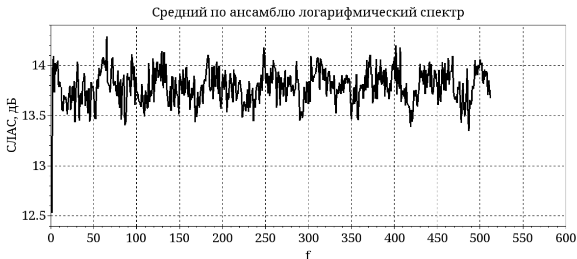
Рис. 1. Средний логарифмический амплитудный спектр, построенный по ансамблю 500 реализаций белого гауссовского шума с двумя переотражениями. Первое переотражение: задержка 17 дискретов, относительный уровень 0.025. Второе переотражение: задержка 34 дискрета, относительный уровень 0.02. По оси абсцисс – номер дискрета быстрого преобразования Фурье.
