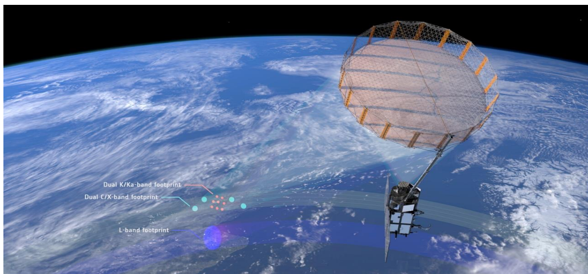
Рис. 3. Синтезированное изображение CIMR на орбите и схема сканирования поверхности [ESA]
