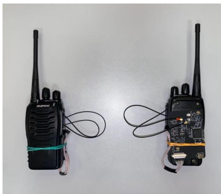
Рис. 4. Внешний вид пары макетов СШП персональных прямохаотических станций диапазона 370 – 600 МГц
