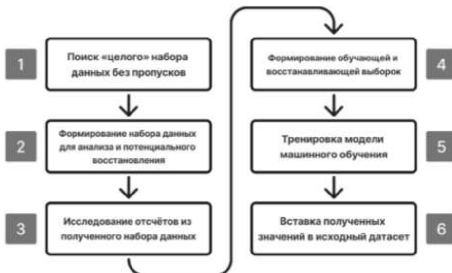
Рис 1. Алгоритм восстановления ПЭС на основе существующих данных и ранее восстановленных
