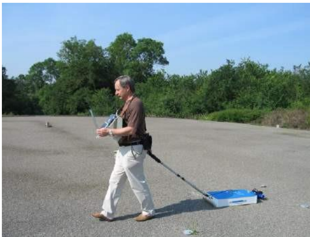
Рис. 13. Георадар ЗОНД-12 с антенной 300 МГц
