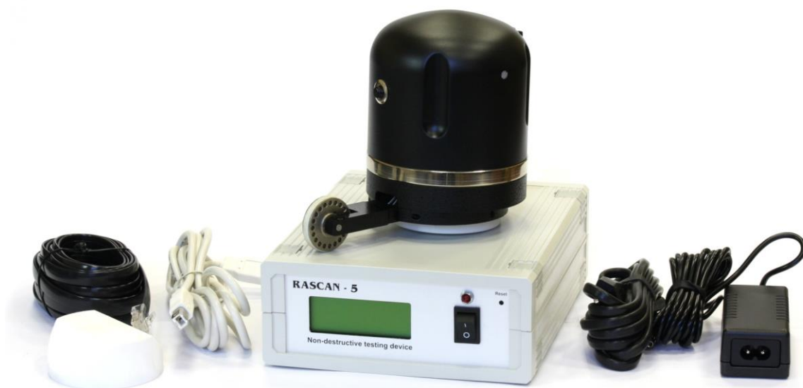
Рис. 8. Голографический подповерхностный радиолокатор РАСКАН, разработанный в Лаборатории дистанционного зондирования
