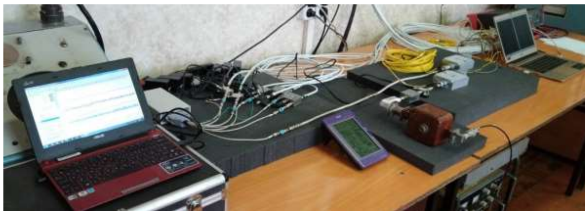
Рис. 7 Состав радиофотонного тракта передачи сигналов промежуточной частоты многочастотной микроволновой радиометрической системы
