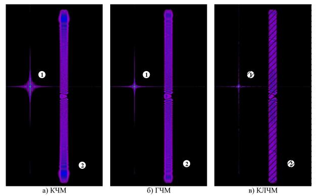
Рис.13. Отклик РСА на точечные цели при смене знака ЧМ зондирующего сигнала
