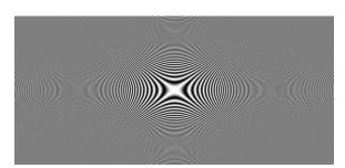
Рис. 6. Действительная часть радиоголограммы (одинаковый знак ЛЧМ)
