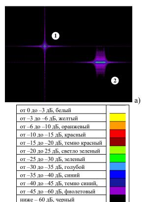
Рис. 8. Отклик РСА с ЛЧМ сигналом на точечную цель из основной зоны съемки (под цифрой 1) и из 1-ой зоны неоднозначности (под цифрой 2): А) при зондировании одинаковыми ЛЧМ сигналами; Б) при зондировании ЛЧМ сигналами с поочередной сменой знака скорости частотной модуляции
