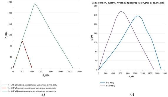
Рис. 1. Результаты расчета лучевых траекторий в координатах высота над поверхностью Земли и длина вдоль лучевой траектории:
