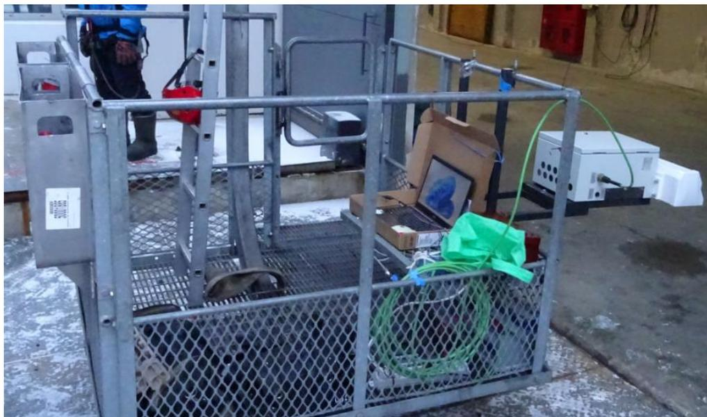
**Рис. 4. Технологическая тележка с установленным радиолокатором перед экспериментом.**
