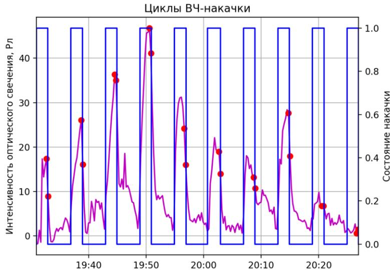
**Рис. 1. Формирование выборки для величины интенсивности свечения ( $b$ ) за один цикл накачки. Интенсивность свечения  $b$  вычисляется как среднее между двумя точками на красной линии, указанными для каждого цикла воздействия (синяя линия). По данным за 15.03.2010 г.**
