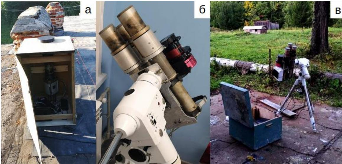
**Рис. 1. Общий вид оптической системы KEO Sentinel (а) и фотометрического макета, состоящего из 3-х канального фотометра и ПЗС камеры 557.7 нм (б, в).**
