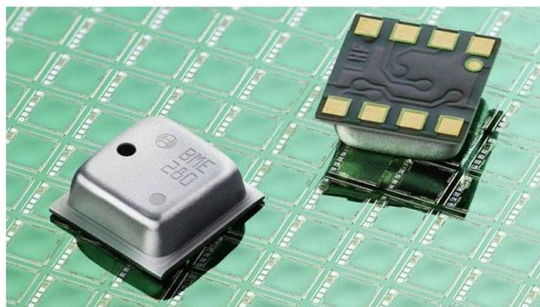
**Рис. 1. Измерительный датчик ВМЕ280**
