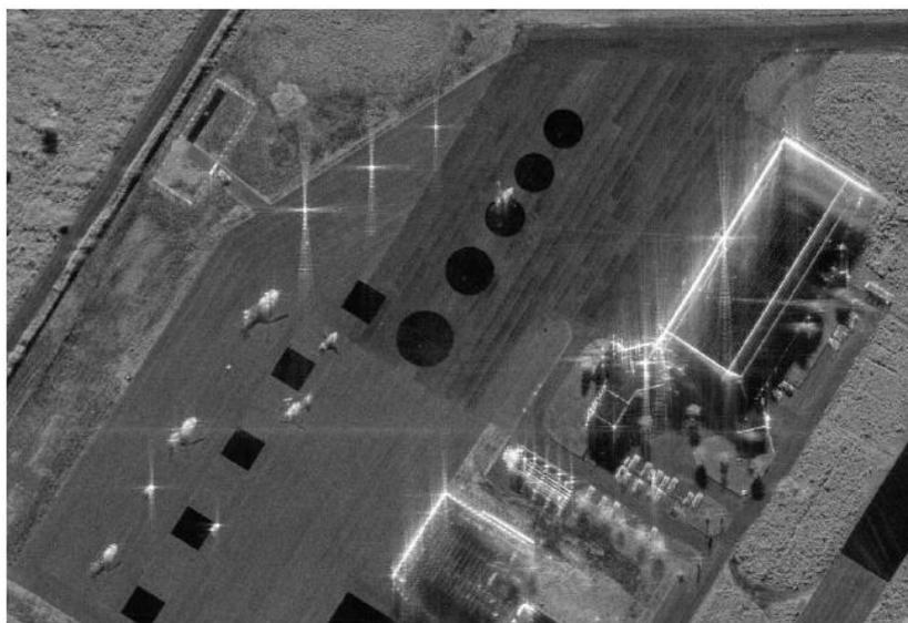
**Рис. 1. Вид радиолокационного изображения (РЛИ) вертолетной площадки с разрешением около 10 сантиметров**
