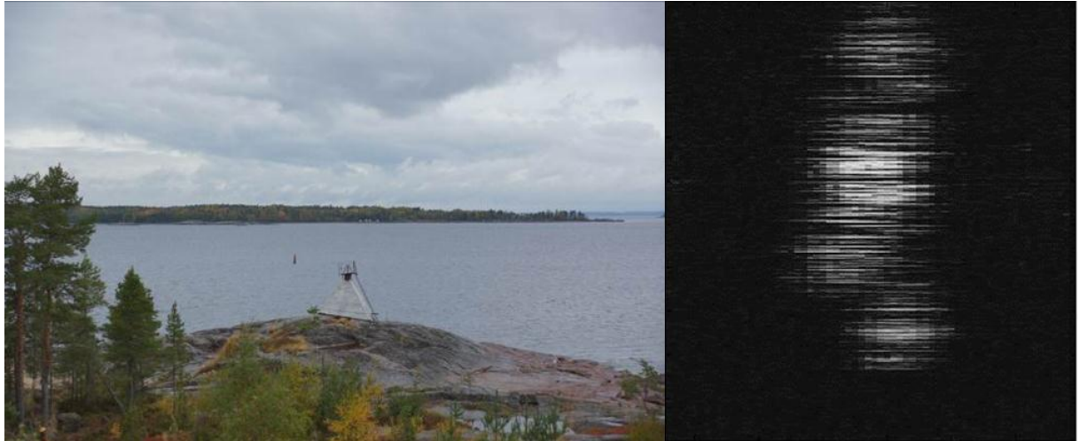
Рис.6. Радиолокационное изображение местности СКИ РЛС: острова. (масштаб развертки радиолокационного изображения 600 м)
