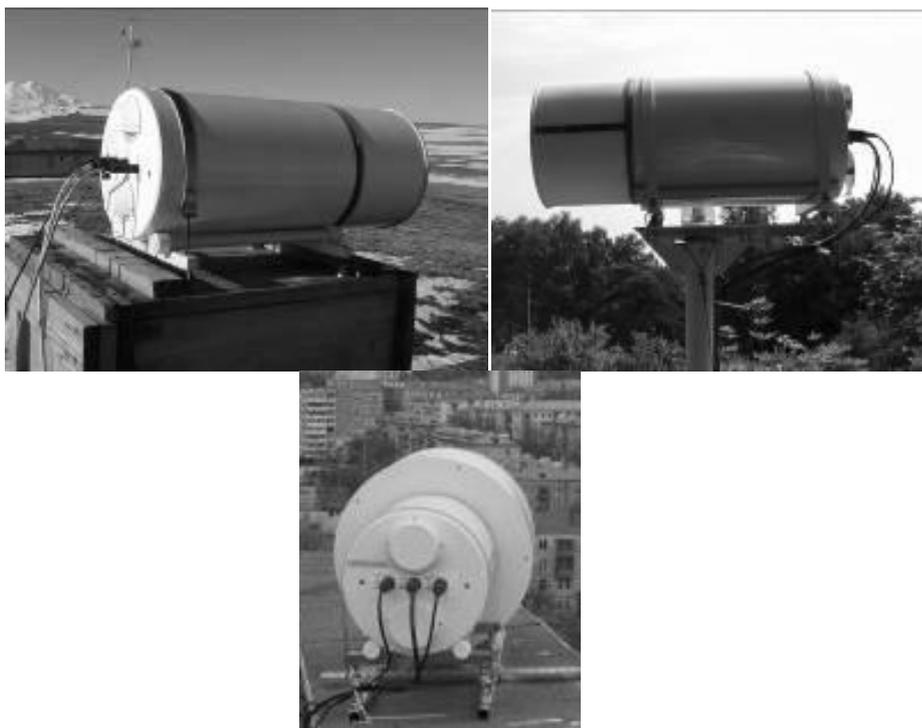
**Рис.1. Микроволновые температурные профиломеры МТР-5 для измерения профилей температуры атмосферного пограничного слоя (крайний справа - полярная версия)**
